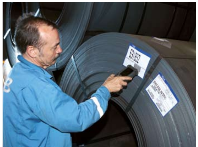
Avläsning med radiolänkanknuten streckkodsläsare.
