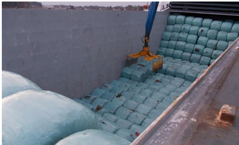
Figur 2. Lossning av fartyg med RDF i bulk (foto: Oxhamn)
