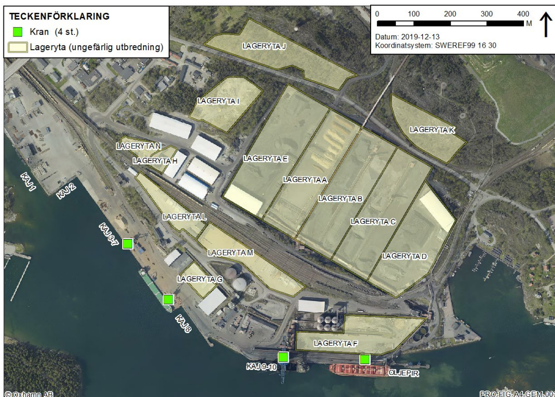
Figur 11. Lagerytor och placering av spårbundna kranar inom hamnen. Lageryta J och K är områden som för närvarande inte ianspråktagits.
